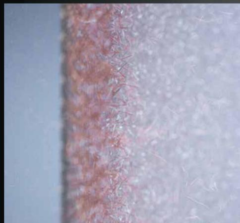
Bei jedem Waschgang werden zahlreiche Mikroplastikfasern aus synthetischer Kleidung freigesetzt. Der Filter entfernt beim Waschen zuverlässig Mikroplastikfasern größer als 0,045 mm.
